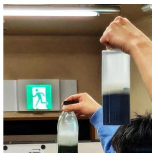
と、水分が砂の上に上昇し砂と分離する(地震による液状化)の実験も行いました。福山駅から南側では、地震によって液状化するので車での避難は危険です。
